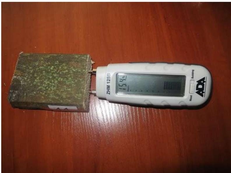
Рис. 3. Измерение влажности образца древесины
