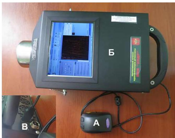
Рис. 1. Подключение лупы видеоспектральной люминесцентной «Регула 4177» (А) к ППИ «Кедр» (Б) через USB порт (В)
