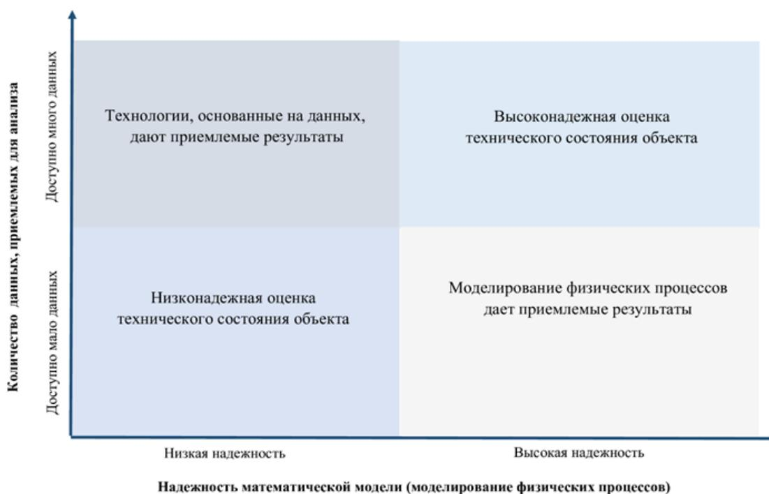
Рис. 4. Схема условий применимости моделирования физических процессов и моделирования, основанного на данных, получаемых с датчиков [9]
