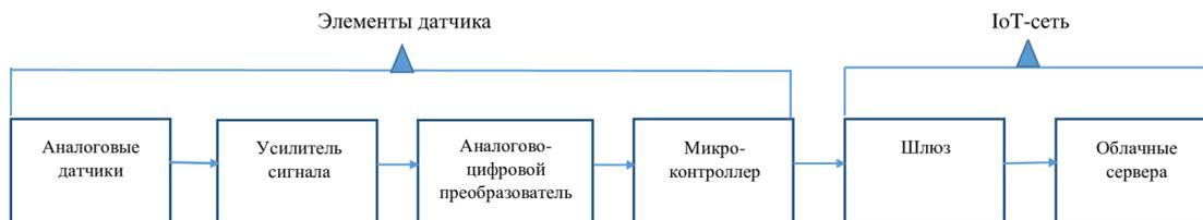
Рис.1. Связь между датчиком и IoT-сетью
