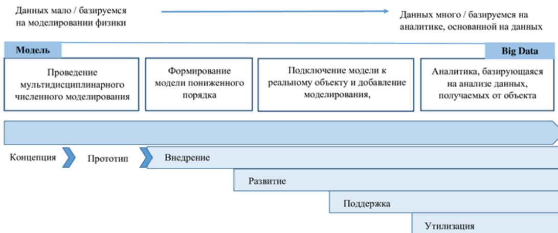
Рис.3. Эволюция цифровой модели на разных этапах жизненного цикла изделия
