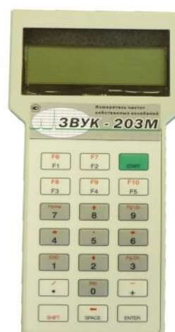
Рис. 1. Внешний вид измерителя частот собственных колебаний «Звук-203М»
