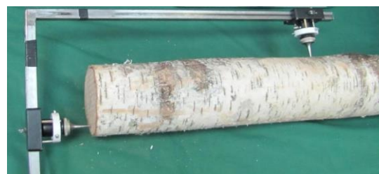
Рис. 4. Расположение преобразователей прибора «Пульсар-1.2» относительно лесо- и пиломатериалов (а) и приспособление для выполнения угловых измерений с применением стандартных преобразователей прибора «Пульсар-1.2» – угольник цифровой для продольно-поперечного прозвучивания
