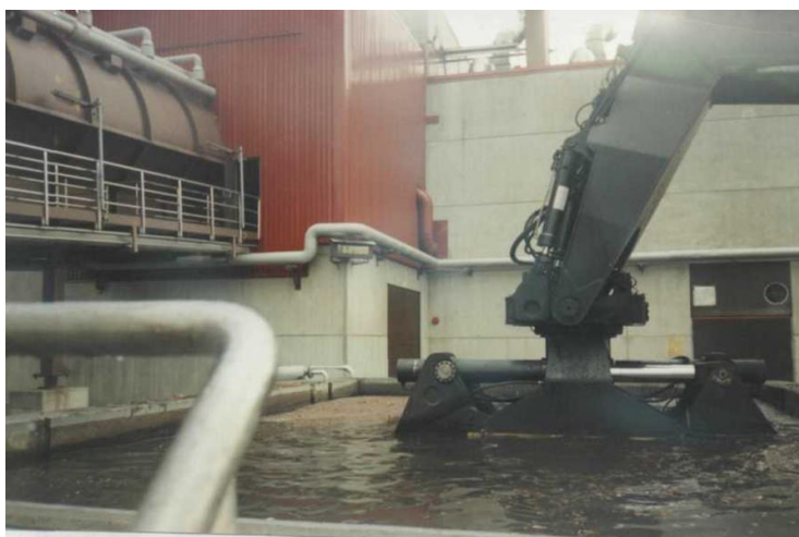
Рис. 3. Рабочий момент измерения объема бревен гидростатическим методом (с применением специально созданного измерительного комплекса, в состав которого входят весы для статического взвешивания погрузчика бревен)
