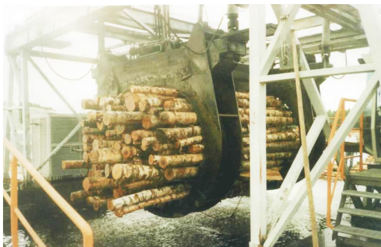
Рис. 2. Пакет бревен в захвате грейфера установки для измерения объема бревен гидростатическим методом (датчик весоизмерительного устройства размещен на грейфере)
