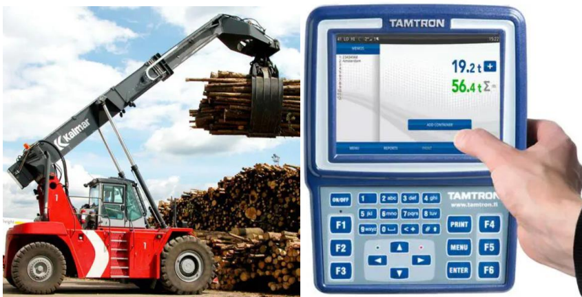
Рис. 1. Встроенная система взвешивания лесоматериалов Tamtron Power Log
