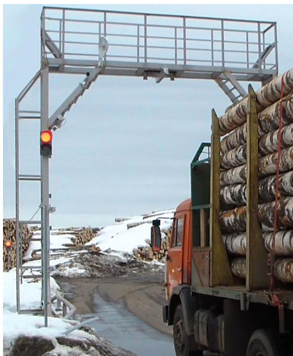
Рис. 5. Электронно-оптический метод определения объема лесоматериалов с использованием прибора ФОТОСКАН-Т/Л – сканирование производится с помощью лазерных триангуляторов 2D профилометров
