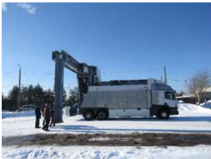
Рис. 2. Современный российский мобильный инспекционно-досмотровый комплекс СТ-2630М
