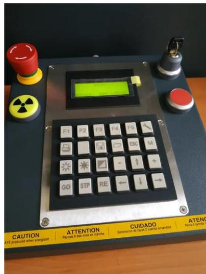
Рис. 2. Клавиатура сканеров B-SCAN 16HR
