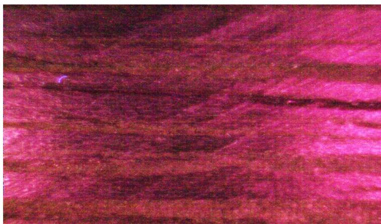
Рис. 2. Люминесценция венге под воздействием ультрафиолетового излучения
