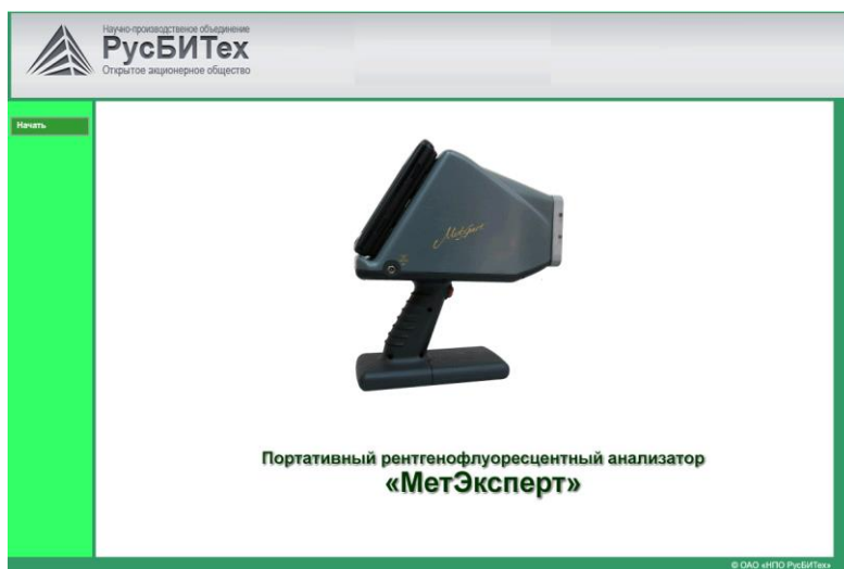
Рис. 1. Обучающий тренажер «Портативный рентгенофлуоресцентный анализатор «МетЭксперт»
